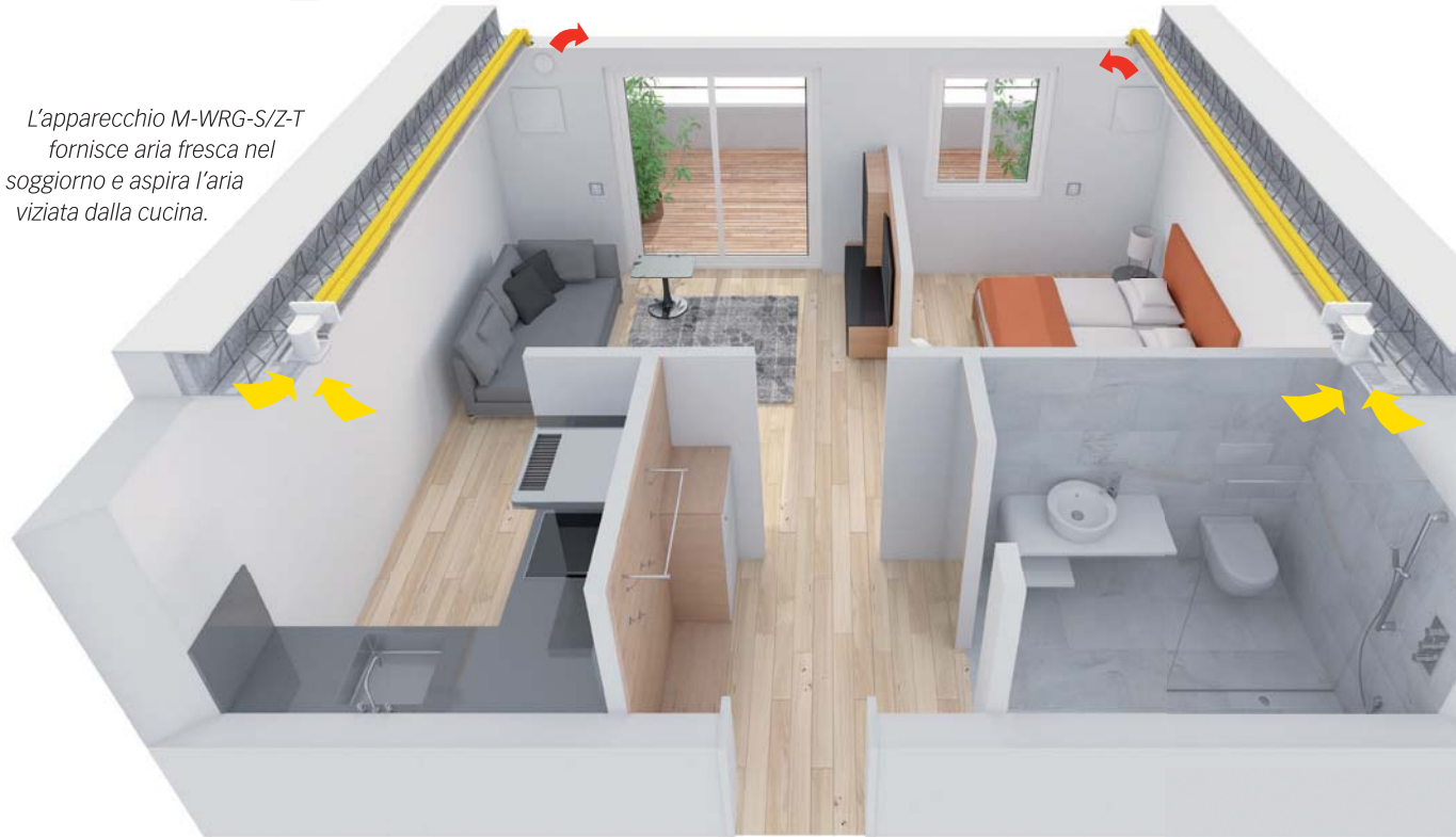
Immagine 19.1 Anche con un apparecchio di ventilazione completamente incorporato (U 2 ) è possibile collegare un secondo locale. Lo spessore minimo del muro deve essere di 24.5 cm
