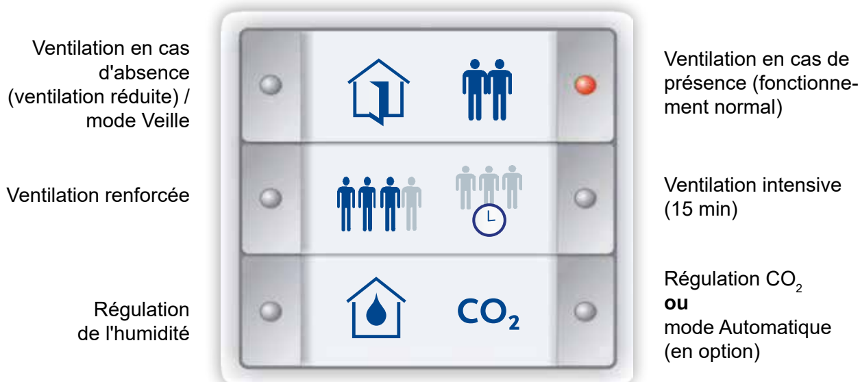
Fig. 17 : Capteur à touche InControl pour M-WRG-II P-T-FC et M-WRG-II E-T-FC
