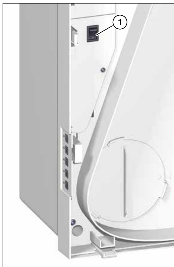
Fig. 18 : Interrupteur d'alimentation, visible après enlèvement du couvercle de l'appareil
