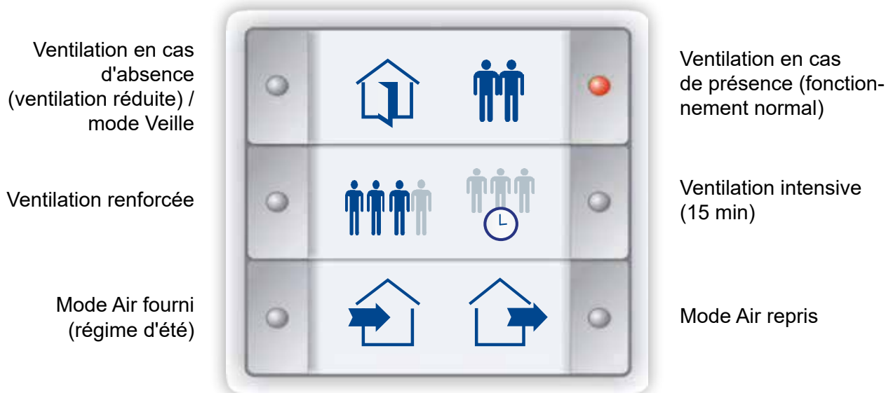
Fig. 15 : Capteur à touche InControl pour M-WRG-II P-T et M-WRG-II E-T
