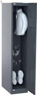
Schrank aus sendzimirverzinktem, pulverbeschichtetem Stahlblech, je 4 Trocknungsarme aus Aluminium mit speziellen Kunststoff-Trocknungsdüsen für Schuhe (2 Paar) und Handschuhe (2 Paar) sowie 2 herausnehmbare Ausblas-Kleiderbügel aus Edelstahl (Air Hanger) für das Aufhängen von Jacken und Hosen.
