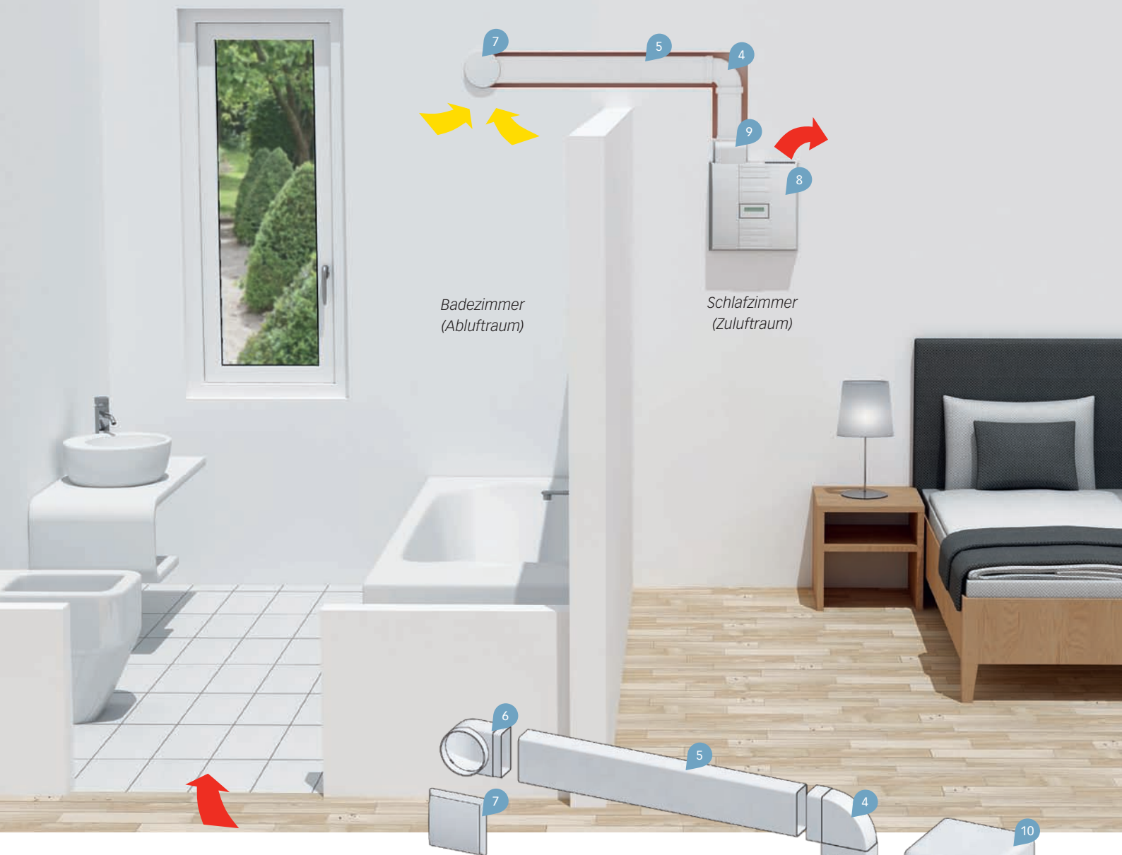
Bild 21.1 Das Schlafzimmer wird über das M-WRG Gerät mit Frischluft versorgt. Die verbrauchte Luft wird über ein Abluftventil im Badezimmer abgesaugt. Die Zuluft für das Bad erfolgt über eine unver-schliessbare Überstromöffnung (z.B. Türunterschnitt).
