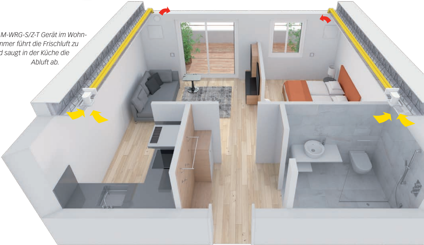
Bild 19.1 Auch bei einem komplett eingebauten Lüftungsgerät (U 2 ), kann ein zweiter Raum angeschlossen werden. Die Mindestwandstärke beträgt 24.5 cm
