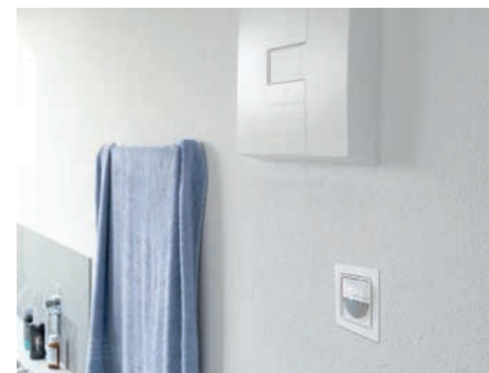
Bild 25.1 Alle M-WRG Geräte sind optional mit einem 230 Volt Steuereingang inkl. Nachlaufrelais erhältlich. Damit kann das Lüftungsgerät über einen externen Befehlsgeber (z.B. Bewegungsmelder) für eine bestimmte Zeit in eine hohe Stufe geschaltet werden. Ideal geeignet für Räume mit Bad/Dusche/WC.
