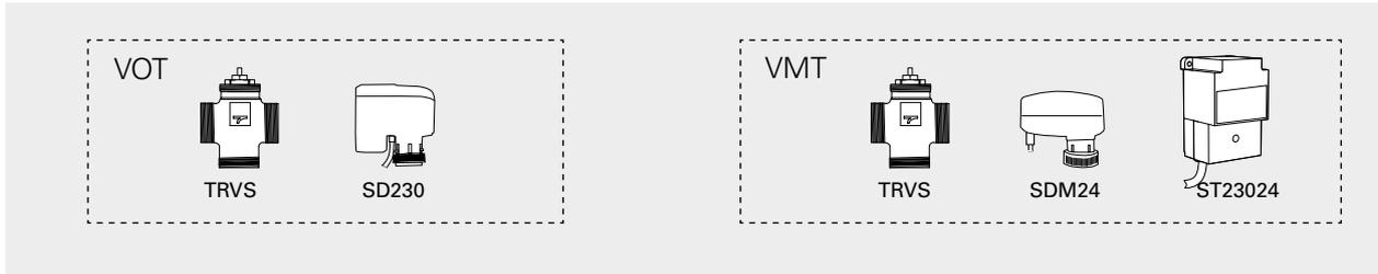
VOT, 3-Wege-Regelventil mit Stellmotor, Ein/Aus 3-Wege-Regelventil mit Stellmotor, Ein/Aus, DN15/20/25. 230V.
