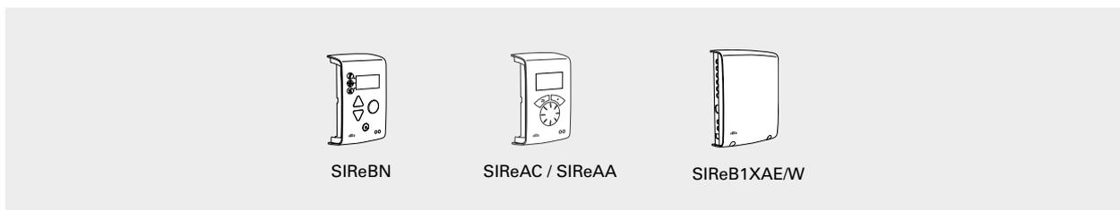
Dieser Luftschleier wird durch das SIRE-Steuersystem über eine externe Leiterplatte geregelt. Ein SIRE kann bis zu neun Luftschleier AR200 steuern. Jeder AR200 benötigt dabei eine externe Leiterplatte SIREB1XA.
