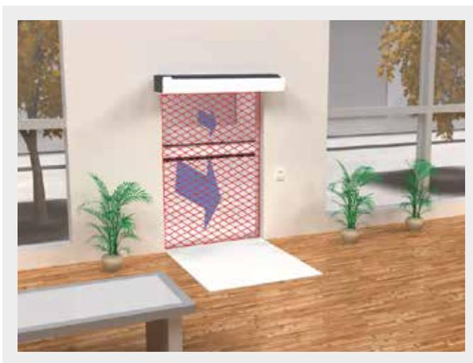
Durch Festlegung von Vorgaben für die Luftgeschwindigkeit und die Symmetrie des Luftstroms in Bodenhöhe erhalten Sie einen Luftschleier, der die gesamte Türöffnung abdeckt.
