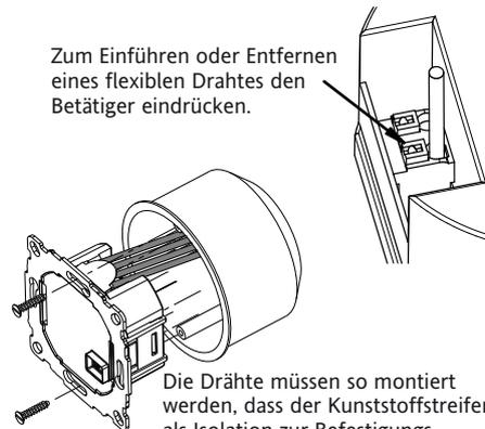
Die Drähte müssen so montiert werden, dass der Kunststoffstreifen als Isolation zur Befestigungsschraube wirkt.
