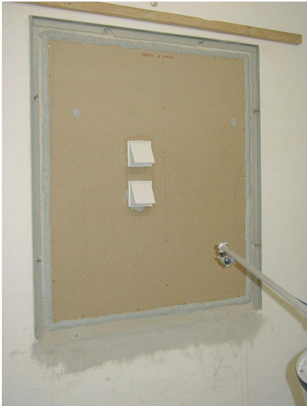
**Ansicht der Zu- und Abluftöffnungen mit Fassadenabschluss aus Edelstahl vom Empfangsraum**
