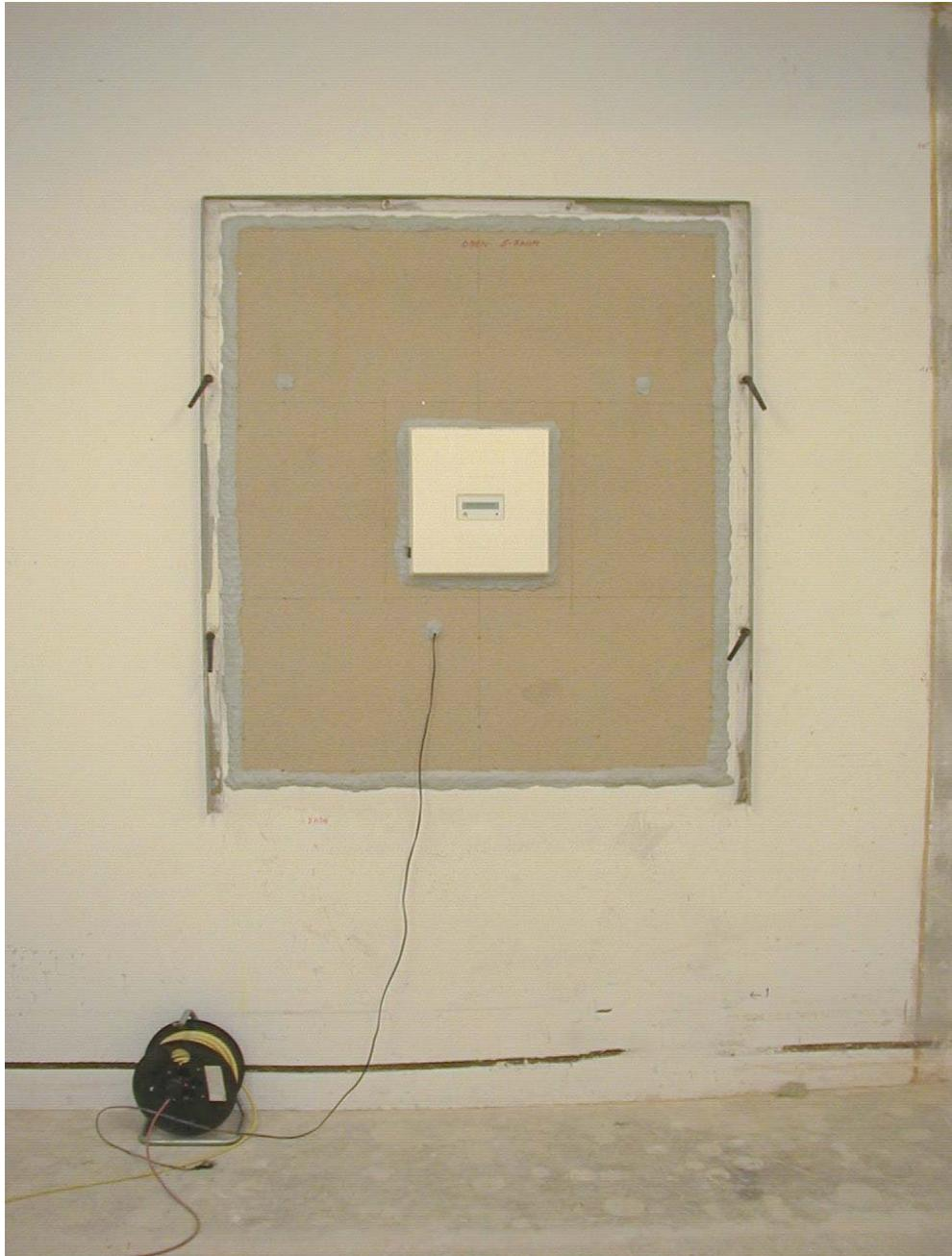
**Ansicht der Rückseite des Lüftungsgerätes, Ausführung Unterputz vom Empfangsraum (ohne empfangsraumseitige Verkleidung und ohne Hohlraumbedämpfung aus Mineralfaser)**
