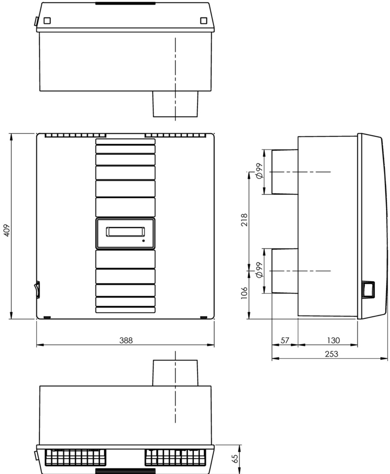
**Ansicht des Lüftungsgerätes, Ausführung Unterputz
