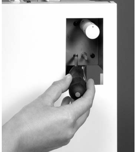
Fig. 2 Capillaire buisregelaar vastschroeven
