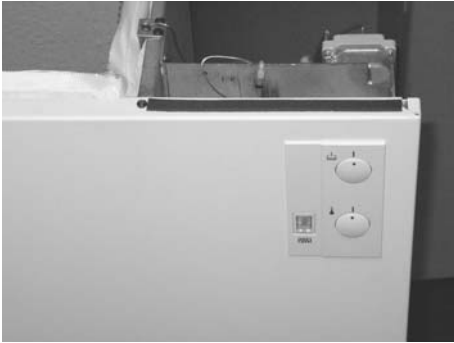
Fig.6 Junta en el borde superior del panel frontal
