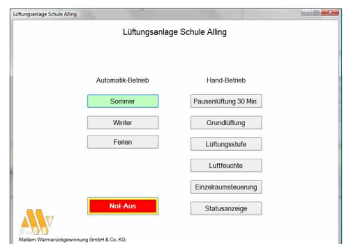
Bedienung zentral mit Touchscreen
