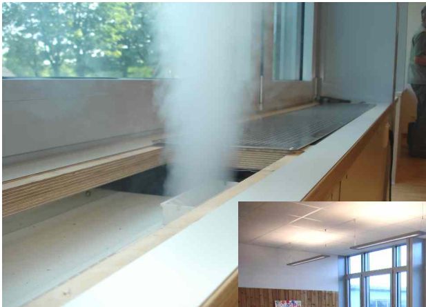
Nebelversuch zeigt zug-freies Ausblasen der gefilterten und erwärmten Zuluft nach oben
